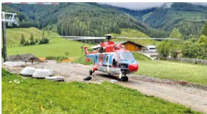
Heli Austria hatte die Supa Puma im Einsatz, da dieser Hubschrauber bis zu 4.500 kg heben kann. Insgesamt musste einige Male mit Hilfe eines Tankwagens nachgetankt werden, da die Supa Puma knapp drei Stunden lang brauchte, um sämtliche Stützenteile an der Liftstrecke zu verteilen.
